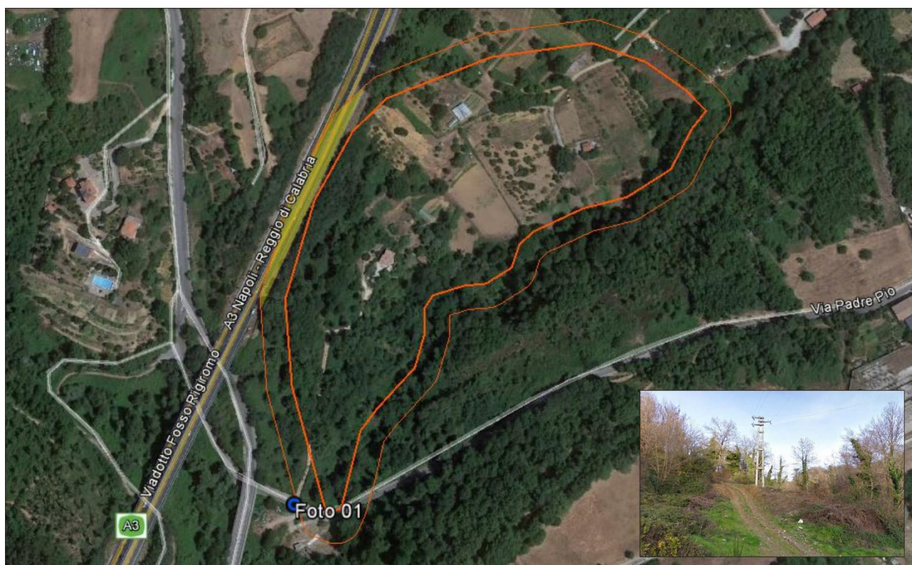
Figura 4 - Corpo di Frana a Pericolosità "P3", associato a Rischio "R2"
